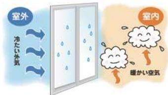
暖かい室内の空気に含まれる水分が外気によって冷やされ、水蒸気の状態ではなくなった水分が付着(結露)
