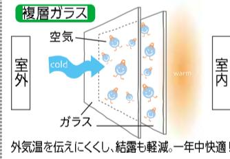
外気温を伝えにくくし、結露も軽減。一年中快適！冬場の玄関の寒さは、ガラスが外気温を伝え、室内の空気を冷やしてしまっているのが原因の一つ。複層ガラスなら高い断熱性能で外気温を室内に伝えにくく、冬場の結露も大幅に軽減。更に1年を通して快適な省エネ効果も期待できます。
