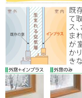
既存の窓と、内窓として取り付けたインプラス、さらにその間に生まれる新しい空気層が室外と室内をしっかりと隔てる構造に。大きな断熱効果で外気温の影響を受けてなくし、結露の発生を抑えます。
