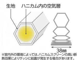
ハニカム(蜂の巣)構造のスクリーン自体の空気層が窓と室内の間に空気層を作り出し、保温性を発揮。暖冷房の効率を高め、室内を冬も夏も快適にします。
